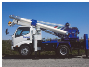
電柱元位置建替作業車「SQUIP (スキップ)」
